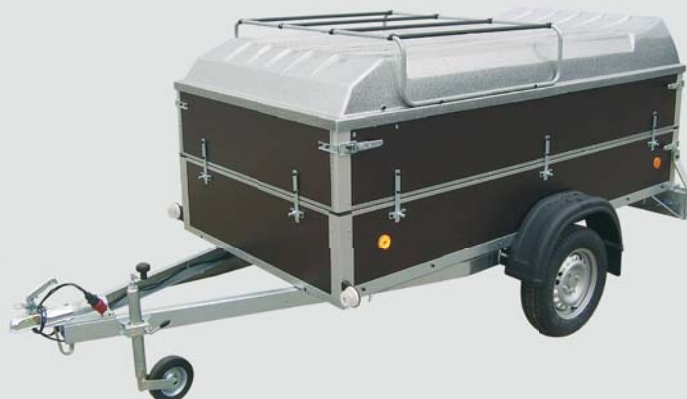
Přívěs VZ-26 s nastavbou bočnic a plastovým víkem
