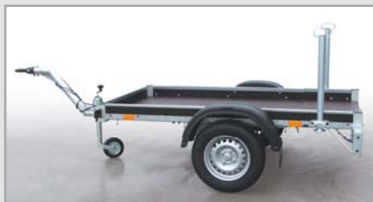
Nebrzděný přívěs VZ-23 plato se zapojením na oko DIN 40
