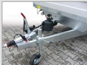
Ruční ovládání hydrauliky u přívěsu Atlas
