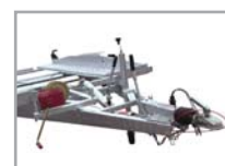
Detail nájezdové brzdy a navijáku u přívěsu PANTER
