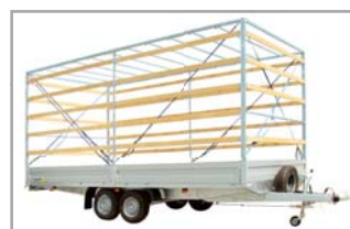
Varianta masivní konstrukce plachty s rovnou střechou
