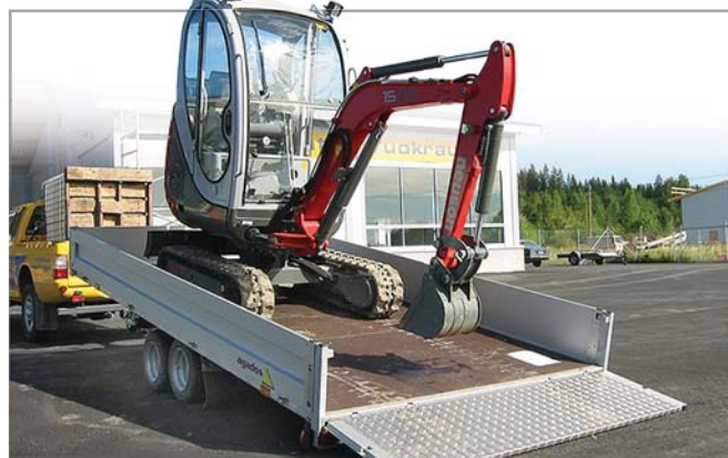
Přívěs ADAM valník s rampou s naloženým minirypadlem
