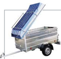
Přívěs NP s nástavbou bočnic 400 mm a uzamykatelným plastovým víkem se zahrádkou
