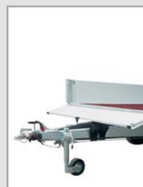
Detail nájezdové brzdy s variantou předního otevíracího čela
