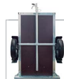
Detail zatahovatelného oje u přívěsu NP pro snadné skladování
