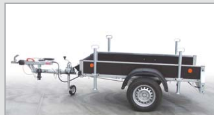
Přívěs VZ-23 plato s výškově stavitelnou ojí
