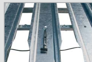
Uchycení nájezdu pomocí gumového třmenu u přívěsů KANGARO
