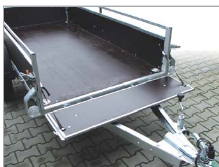
Přední otevírací čelo u přívěsu VZ-26
