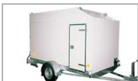
Bílá překližková skříň na podvozku VZ-31 B1 s bočními dveřmi a skosením pro efektivnější proudění větru
