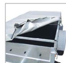
Detail relingu, předního otvíracího čela a plachty na překrytí u přívěsu NP
