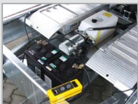
Elektrické ovládání hydrauliky u přívěsu Atlas
