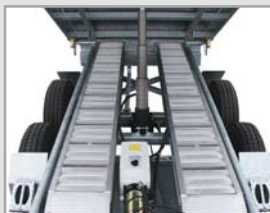
Detaili uložených nájezdů u přívěsů ATLAS
